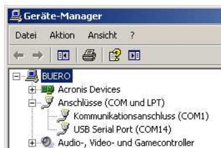
Abb.3: USB-Schnittstelle als virtueller COM-Port
